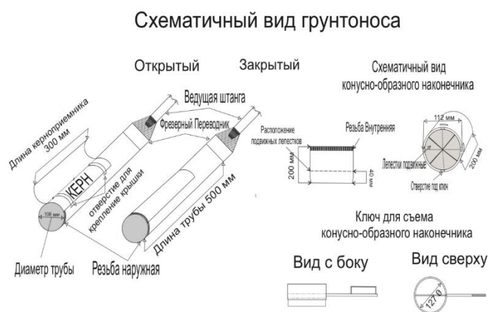
Рис. 1. Схематичный вид предлагаемой конструкции грунтоноса.
